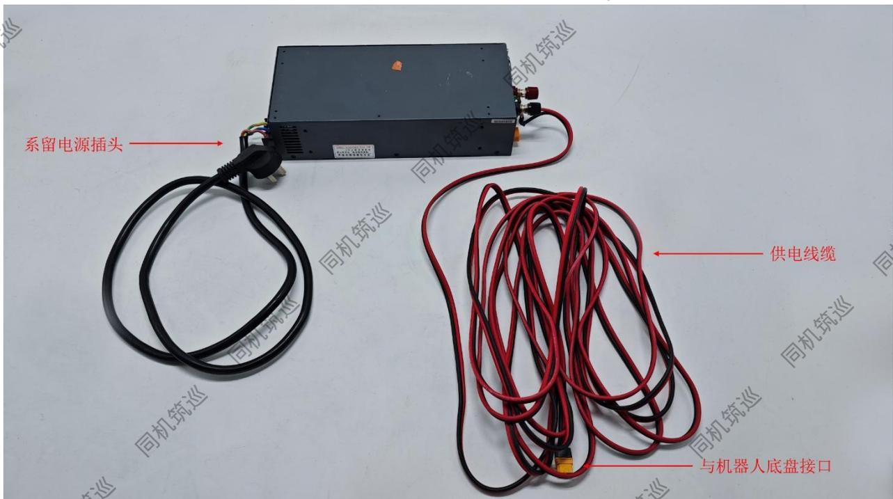
系留电源与供电线缆示意图
