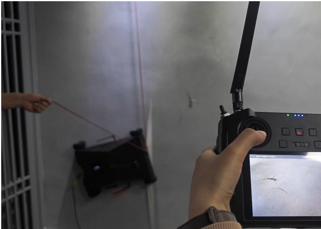
12. 两边同时往后拨动摇杆，机器人底盘向后方移动；
