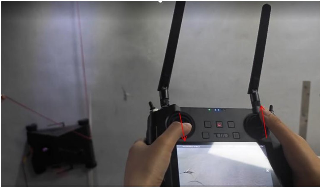
14. 左杆向上，右杆向下，机器人底盘向右旋转；
