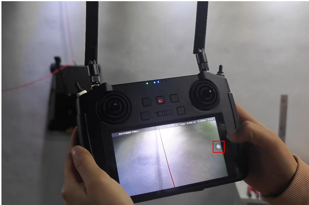
10. 两边同时往前拨动摇杆，机器人底盘向前方移动；
