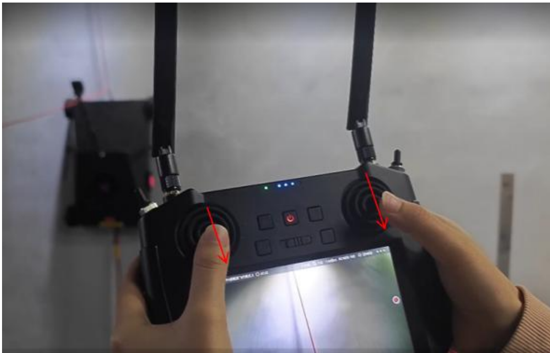
13. 左杆向下，右杆向上，机器人底盘向左旋转；
