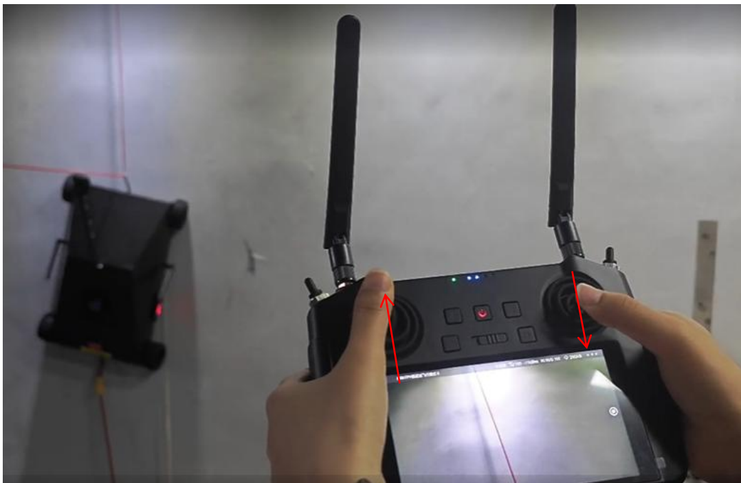
15. 作业完成后，逆时针扭动调速控制器使其关闭；
